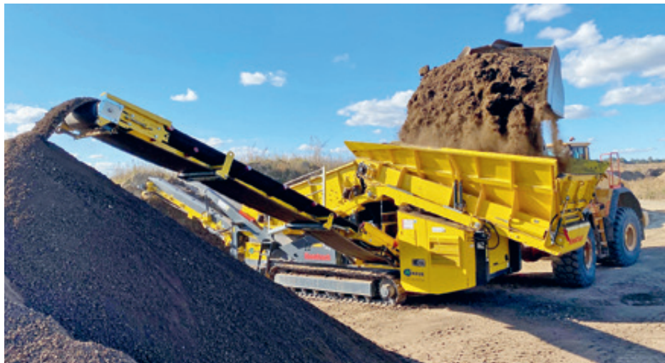
Die raupenmobile Plattenband-Schwerlast-Siebanlage Keestrack K4 bietet eine Leistung von bis zu 350 t/h. Der XXL-Aufgabebunker, der bei der Firma Winter Transporte zum Einsatz kommt, verfügt über ein Volumen von ca. 10 m 3 .
